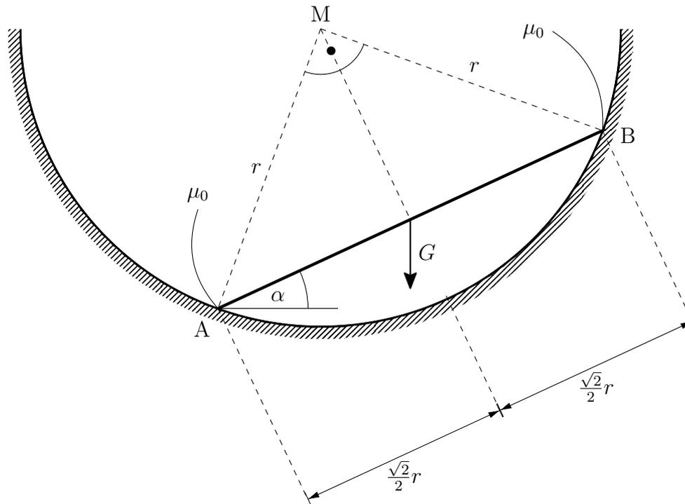
Auf einer halbkreisförmigen Unterlage (Radius  $r$ , Mittelpunkt  $M$ ) liegt ein Stab (Gewichtskraft  $G$ , Länge  $\sqrt{2}r$ ) unter einem Winkel  $\alpha$  gegen die Horizontale. An beiden Auflagerpunkten  $A$  und  $B$  haftet der Stab an der Unterlage über den Haftkoeffizienten  $\mu_0$ .
