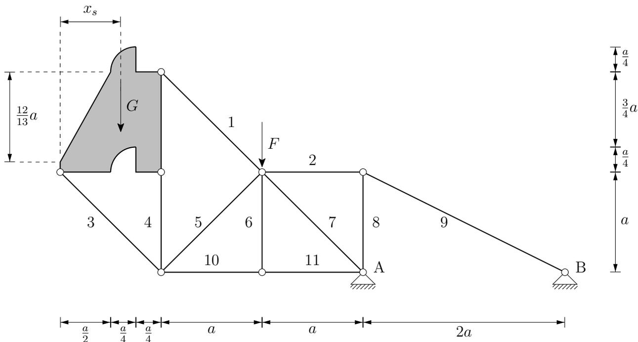
Das dargestellte Tragwerk besteht aus 11 Stäben und einer starren Scheibe (grau). Es wird durch die Kraft  $F$  und durch die Gewichtskraft  $G$  (im Schwerpunkt der starren Scheibe) belastet.
