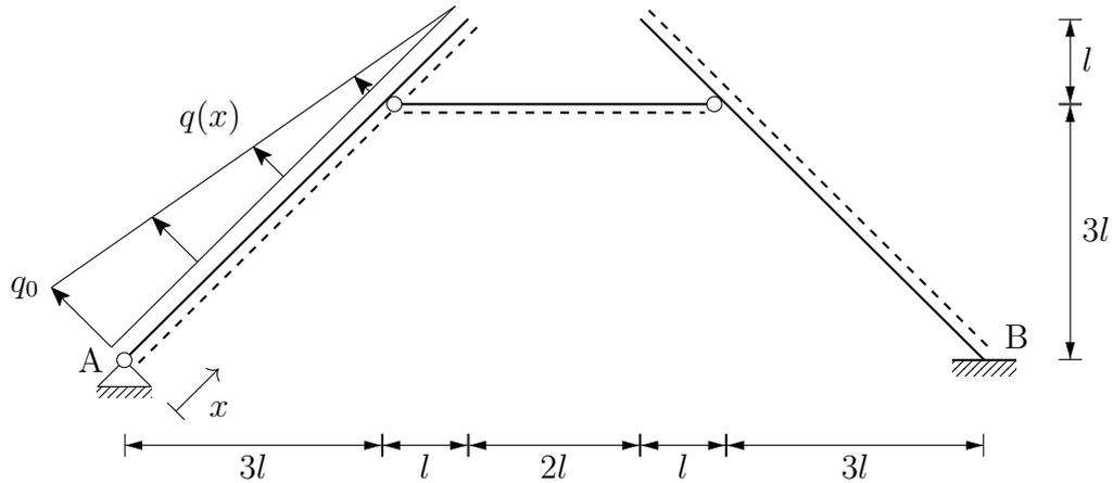
Das dargestellte Tragwerk besteht aus drei gewichtsfreien starren Teilkörpern, die über Gelenke miteinander verbunden sind. Das Tragwerk ist in den Punkten A und B gelagert und wird durch eine dreieckförmige Streckenlast  $q(x)$  belastet.
