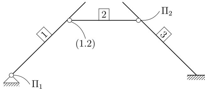
→ Tragwerksteil 3 ist eingespannt ⇒ unbeweglich.
