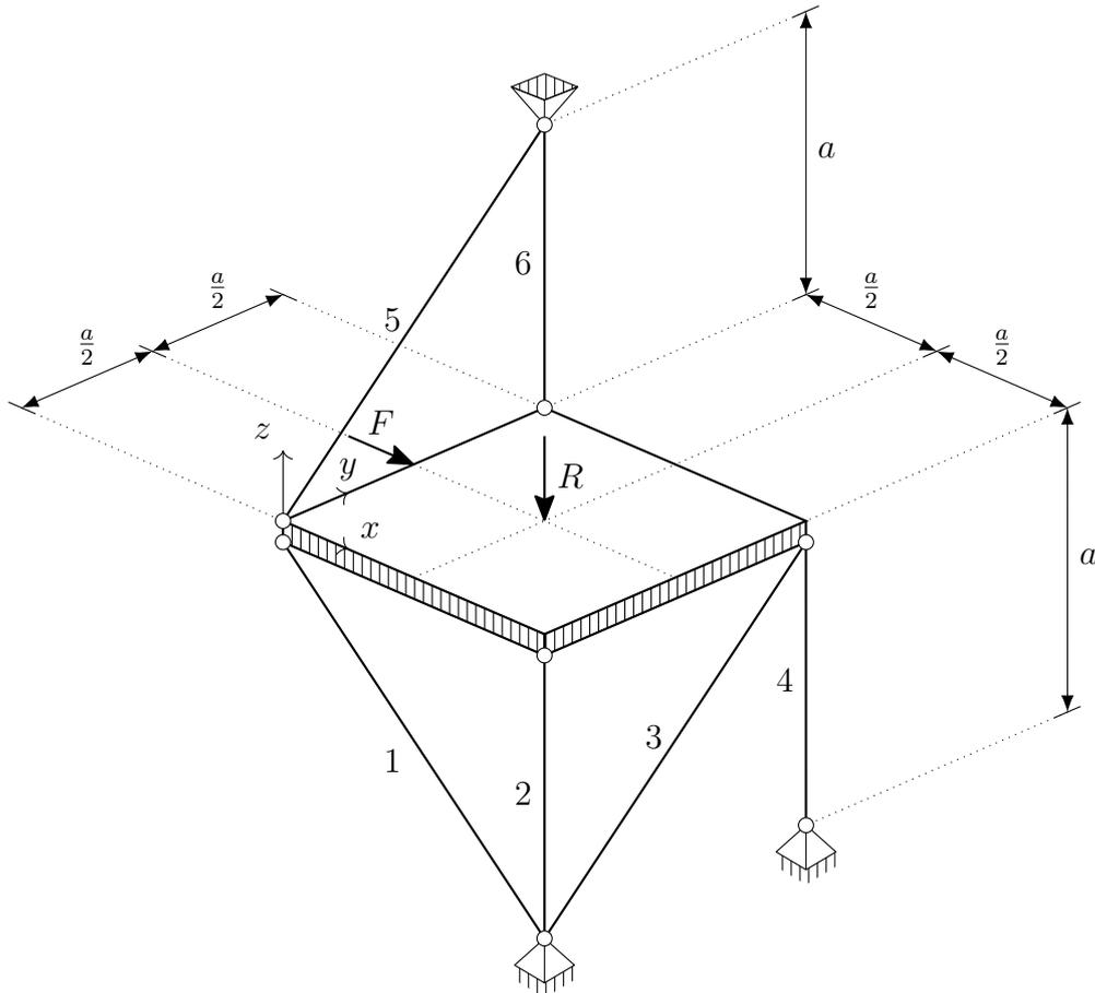
Eine quadratische Platte mit vernachlässigbarer Dicke und der Kantenlänge  $a$  wird von insgesamt sechs Stäben gehalten (siehe Abbildung). Die einwirkenden Kräfte können durch das zentrale Kraftsystem ( $\mathbf{F} = F \mathbf{e}_x$ ,  $\mathbf{R} = -R \mathbf{e}_z$ ) zusammengefasst werden.
